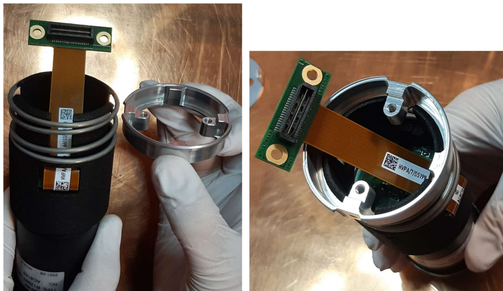
Photo 7 : mise en place de la bague en aluminium
