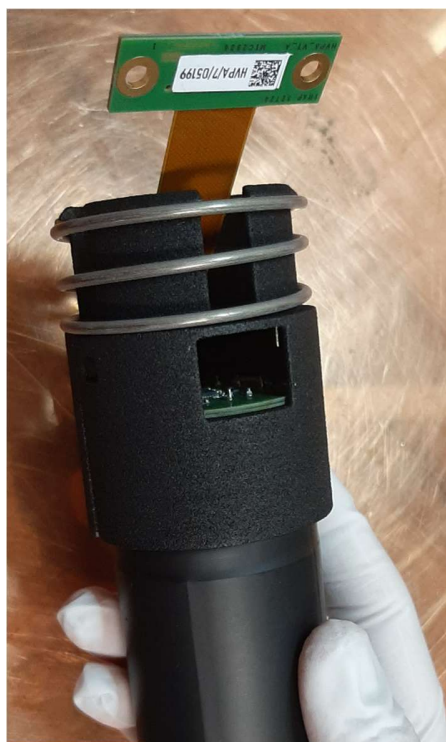
Photo 6 : mise en place du ressort
