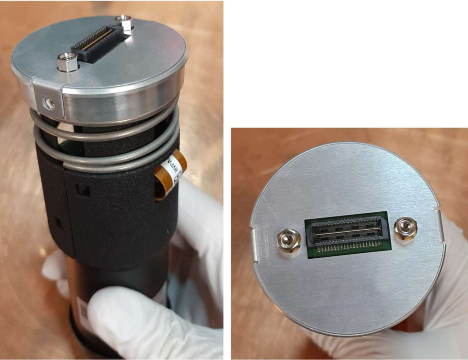
Photo 9 : positionnement du capuchon en aluminium
