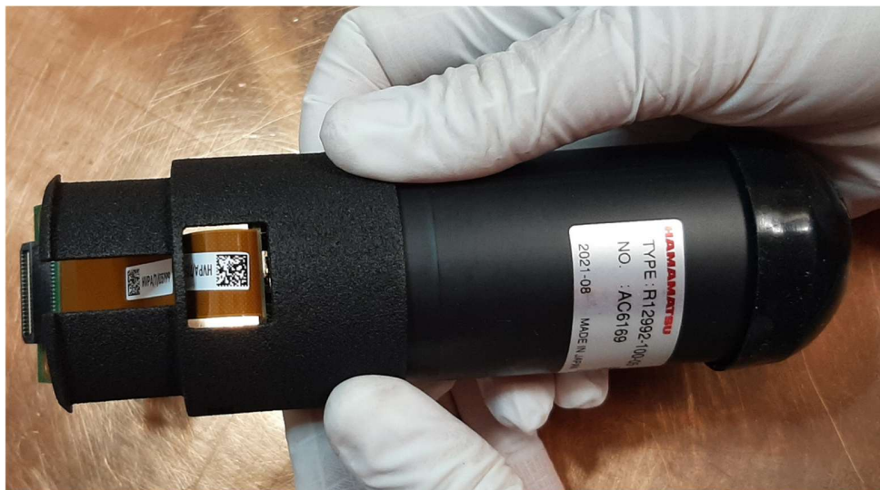
Photo 3 : passage du flex dans l'encoche prévue à cet effet
